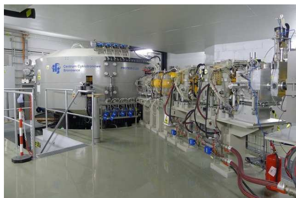
Rys. 5. Cyklotron Proteus C-235 oraz jedno z dwóch stanowisk gantry w Centrum Terapii Protonowej w Bronowicach. Stanowiska te powinny rozpocząć terapie w IV. kwartale 2015 r.
