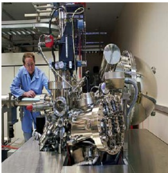
Rys.5.1 Wygląd zewnętrzny komory MBE (źródło: Internet).
