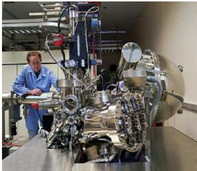
Rys.43. Wygląd zewnętrzny komory MBE (źródło: Internet).
