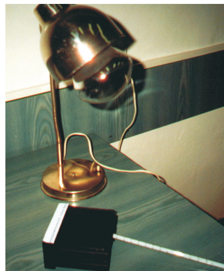
Rys. 3. Model powietrznego kolektora słonecznego (wykonany przez ucznia), termometr i źródło światła (fot. autor)
