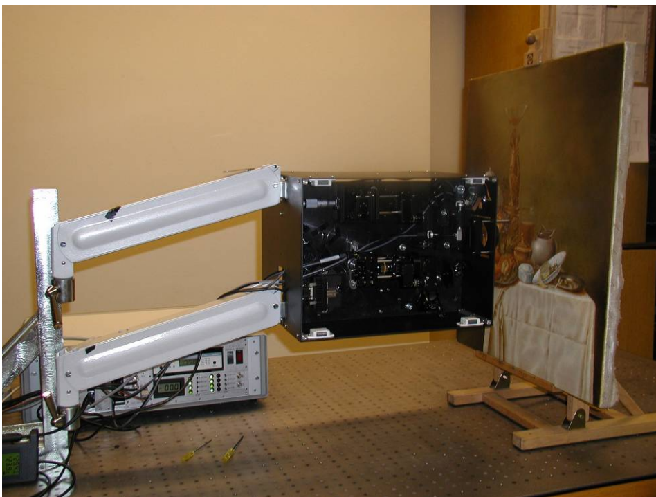
Il. 1. Badanie obrazu sztalugowego za pomocą urządzenia OCT skonstruowanego do celów konserwatorskich: na ilustracji widoczna jest głowica na wysięgnikach zamocowanych do stołu optycznego oraz blok zasilania
