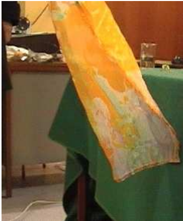
Foto 1 Chustka zdjęta z płaszcza jest naelektryzowana i jest przyciągana przez inne materiały, (natomiast dwa końce chustki się odpychają)
