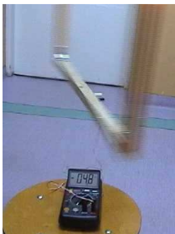
Foto 6A. Zwojnica, zasilana prądem około 3-5A (np. z akumulatora samochodowego) obraca się w polu magnetycznym Ziemi (jest przykładem silnika elektrycznego). Ponieważ w polu magnetycznym Ziemi (około 300mG = 3 \cdot 10^{-8}T ) moment siły jest rzędu 10^{-5}Nm , ramka obraca się bardzo powoli – z tego powodu wymaga zawieszenia na nici pod sufitem a przewody doprowadzające prąd muszą być odpowiednio giętkie.
