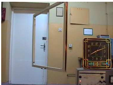
Foto 6A. Zwojnica, zasilana prądem około 3-5A (np. z akumulatora samochodowego) obraca się w polu magnetycznym Ziemi (jest przykładem silnika elektrycznego). Ponieważ w polu magnetycznym Ziemi (około 300mG = 3 \cdot 10^{-8}T ) moment siły jest rzędu 10^{-5}Nm , ramka obraca się bardzo powoli – z tego powodu wymaga zawieszenia na nici pod sufitem a przewody doprowadzające prąd muszą być odpowiednio giętkie.
