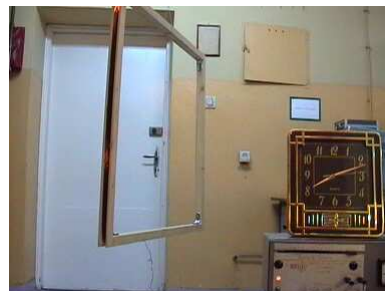
Foto 6A. Zwojnica, zasilana prądem około 3-5A (np. z akumulatora samochodowego) obraca się w polu magnetycznym Ziemi (jest przykładem silnika elektrycznego). Ponieważ w polu magnetycznym Ziemi (około 300mG = 3 \cdot 10^{-8}T ) moment siły jest rzędu 10^{-5}Nm , ramka obraca się bardzo powoli – z tego powodu wymaga zawieszenia na nici pod sufitem a przewody doprowadzające prąd muszą być odpowiednio giętkie.
