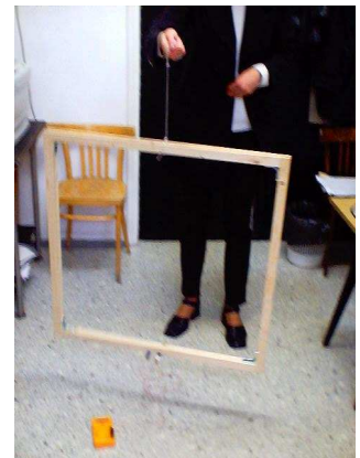
Foto 6. Jeden i ten sam przyrząd, ramka z nawiniętym drutem, ilustruje zarówno prawo Faraday-Lenza (siłę elektromotoryczną indukcji E = -n d\Phi/dt , gdzie n jest ilością zwojów) jak i siłę działającą na przewodnik z prądem w polu magnetycznym (siłę Faradaya, lub siłę Lorentza w przypadku swobodnych ładunków). Na ramkę o wymiarach 1m \times 1m nawinięto około 100 zwojów miedzianego drutu o średnicy 1mm (typowy drut transformatorowy).
