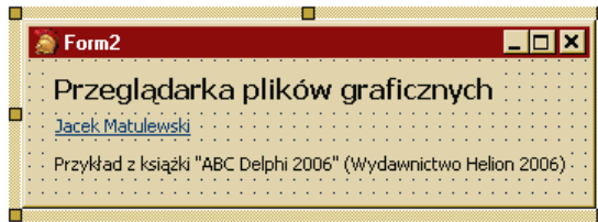
Rysunek 14.10. Najprostszy sposób wykorzystania komponentu TLinkLabel
