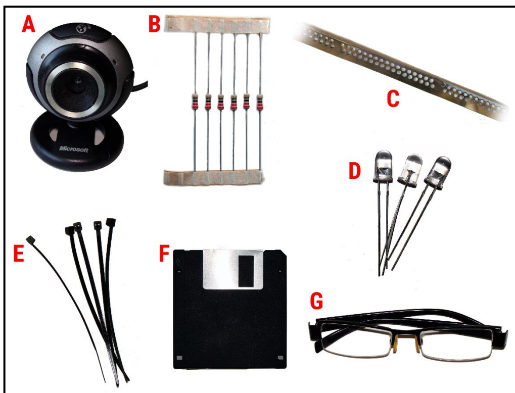
Rysunek 1. Elementy składowe Aparatury: A) kamera internetowa Microsoft VX-3000, B) rezystor, C) kątownik aluminiowy, D) dioda IR, E) zaciski plastikowe, F) dyskietka, G) oprawka okularów
