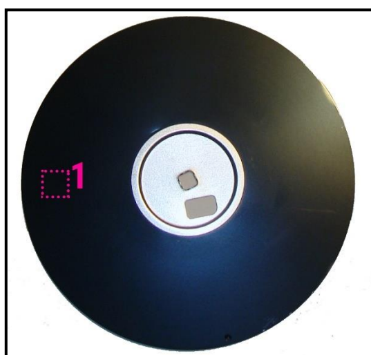
Rysunek 5. Nośnik dyskiety. 1) przykładowy obszar wycięcia filtra podczerwieni
