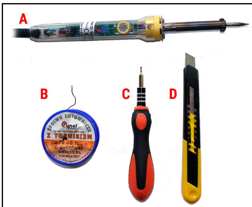
Rysunek 2. Niezbędne narzędzia: A) lutownica, B) cyna, C) śrubokręt, D) ostry nóż
