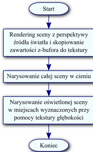
Rys. 19. Diagram przedstawiający trzy przebiegi renderingu wymagane do wykonania obrazu przy pomocy metody mapowania cieni.
