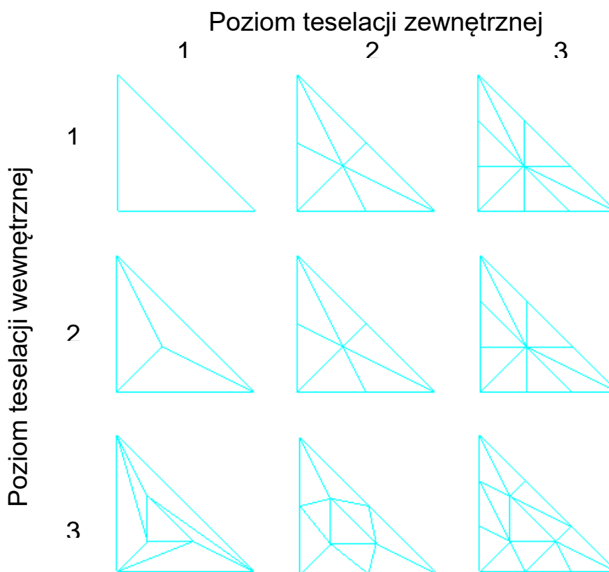
Rys. 1.2. Otrzymane prymitywy w zależności od poziomów teselacji zewnętrznej i wewnętrznej.
